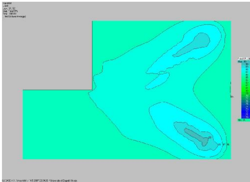
Slika 7. – Raspodjela zvučnog tlaka uz ozvučenje s 2 zvučnika
